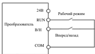
(a) Схема подключения двухпроводного управления (F00.03=0)
