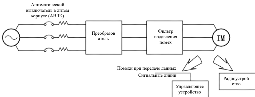
Рисунок 3-7 Установка фильтра подавления помех на выходной стороне
